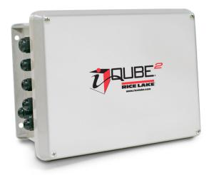
La caja de unión opcional iQUBE2® de diagnóstico digital tiene la capacidad única de monitorear digitalmente y comunicar el comportamiento de las celdas de carga, y compensar aquella que falla hasta que sea reparada. La iQUBE2 ofrece una velocidad y comunicación sin paralelo y es, por mucho, más resistente a descargas electrostáticas y corrientes erráticas provocadas por rayos, que cualquier caja de unión tradicional.
